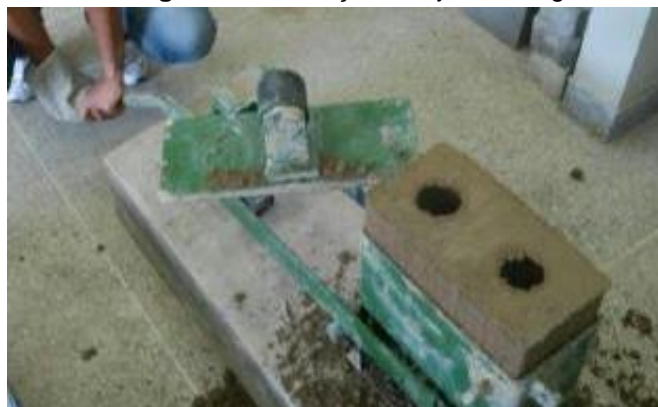
Figura 2. Confeção do tijolo ecológico
