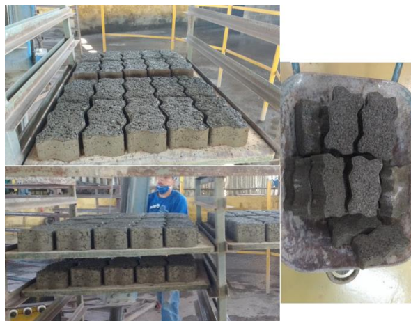
Figura 3. Peças de concreto para pavimentação fabricada com o resíduo industrial
