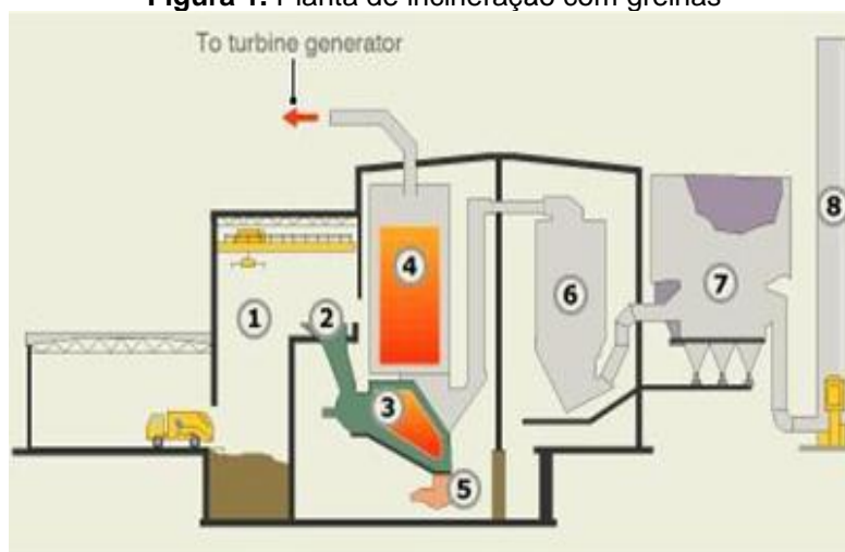
Figura 1. Planta de incineração com grelhas
