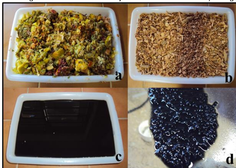
Figura 2. Resíduos que compuseram a mistura afluyente dos biometanizadores. a) FORSU triturada. b) serragem. c) lodo de esgoto sanitário da ETE Monjolinho – São Carlos/SP. d) lodo granulado DACAR
