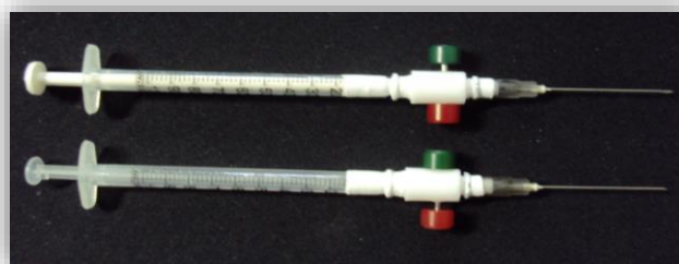
Figura 3. Adaptação de seringas de insulina para a coleta de biogás com posterior análise cromatográfica
