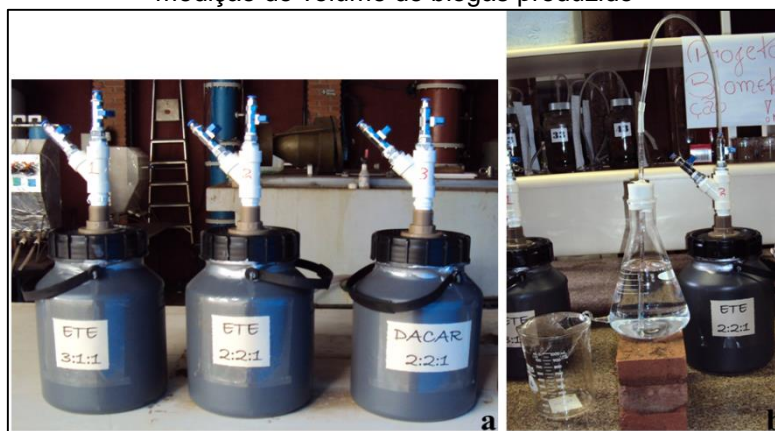
Figura 1. Biometanizadores de 5 L. a) Adaptação em “Y” feita na tampa para a saída e coleta de biogás e para a entrada de alcalinizante. b) Biometanizador conectado ao aparato de Mariotte utilizado para a medição do volume de biogás produzido
