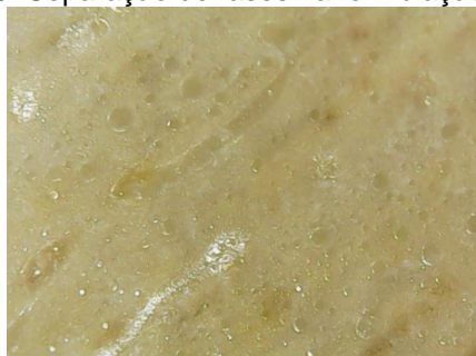
Figura 5. Separação de fases na formulação A
