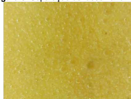
Figura 6. Separação de fases na formulação B
