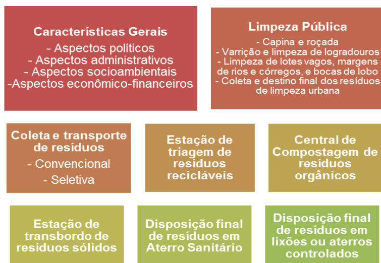
Figura 1 – Principais serviços e estruturas integrantes do sistema de limpeza pública municipal no Brasil
