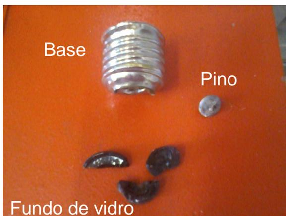
Figura 3: Parafuso de Edison desmembrado
