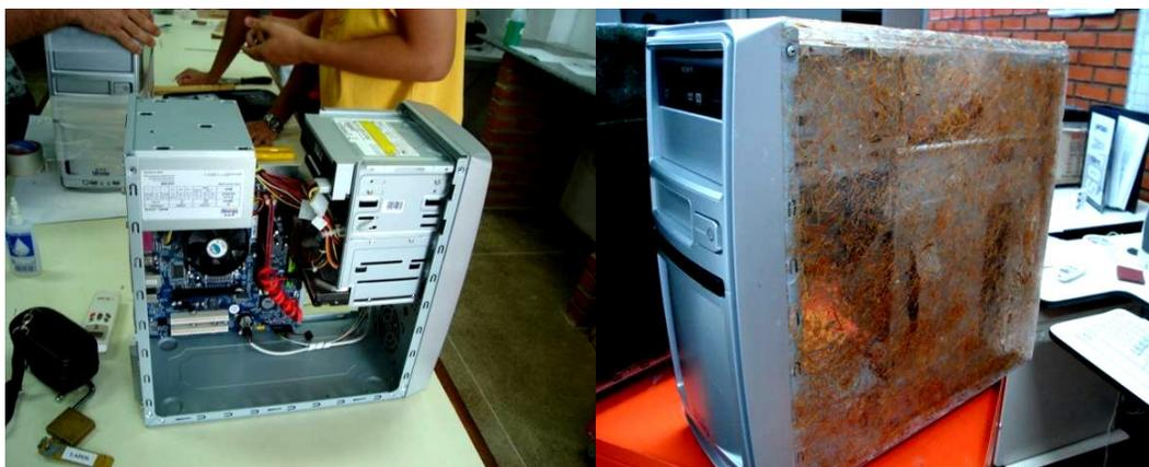
Figura 1- Montagem das placas laterais e superior do gabinete ecológico
