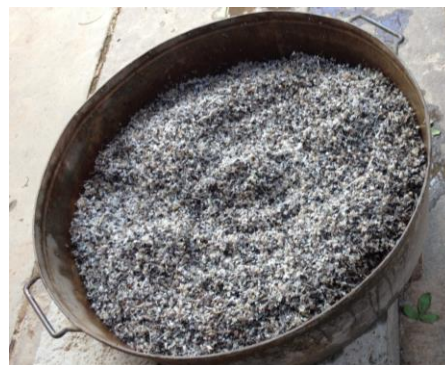
Figura 4 – Material após moagem, com melhor granulometria para enchimento dos puffs
