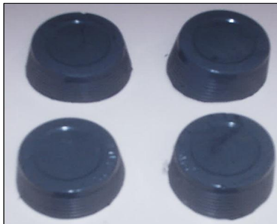
Figura 3. Geopolímeros sintetizadas com CP/M e com a adição de efluente contaminado
