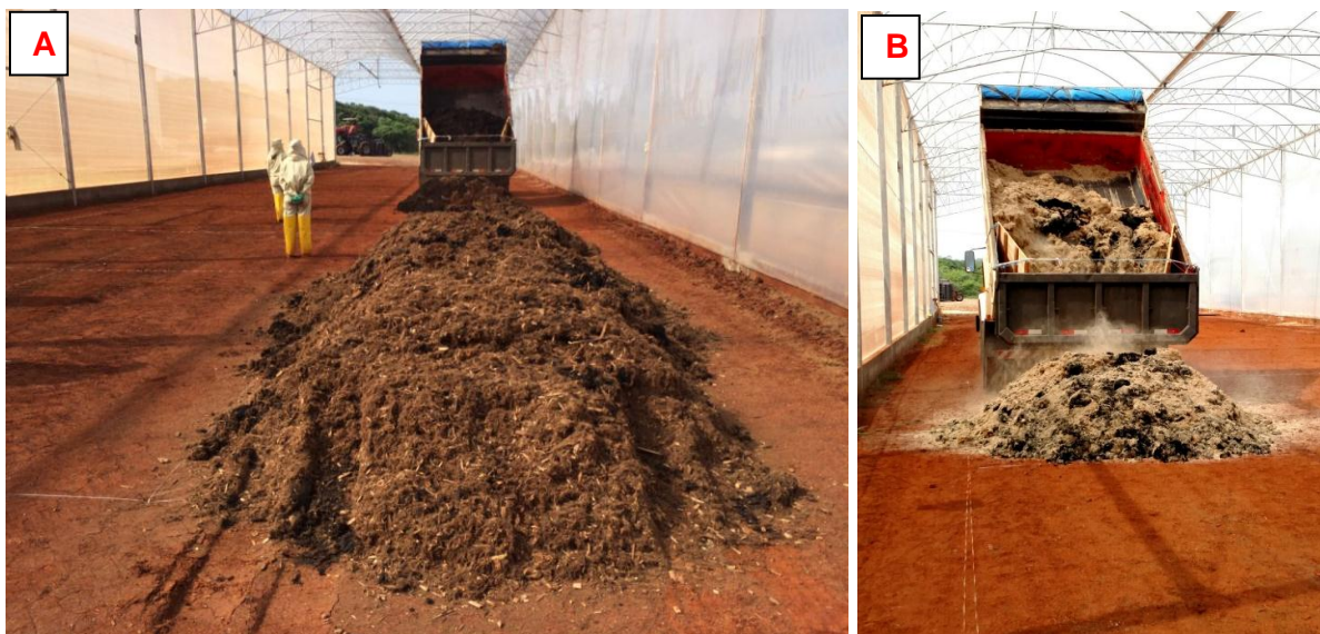
Figura 4. Leira de compostagem recém-revolvida pela máquina compostadora na primeira semana do processo.
