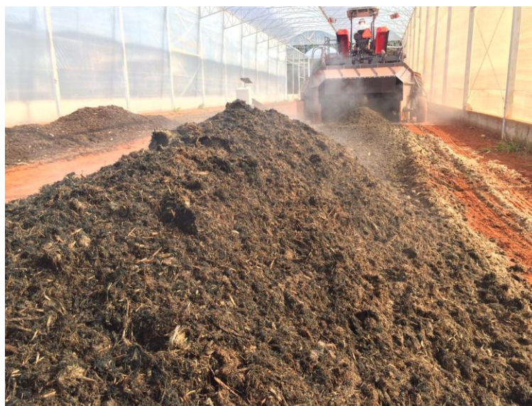
Figura 4. Leira de compostagem recém-revolvida pela máquina compostadora na primeira semana do processo.
