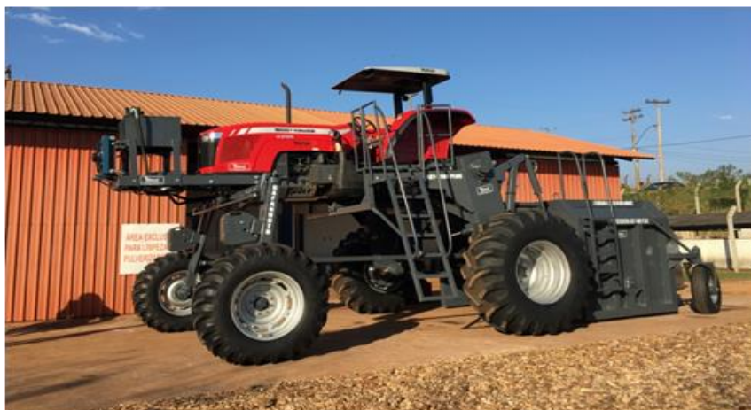
Figura 2 – Máquina compostadora utilizada no revolvimento das leiras.
