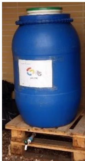
Figura 1. Reator construído a partir de recipiente plástico de 200L
