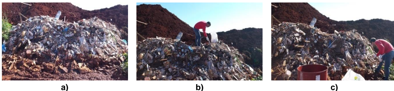
Figura 4 - Coleta da amostra a) Pilha selecionada b) Coleta no topo c) Coleta na base
