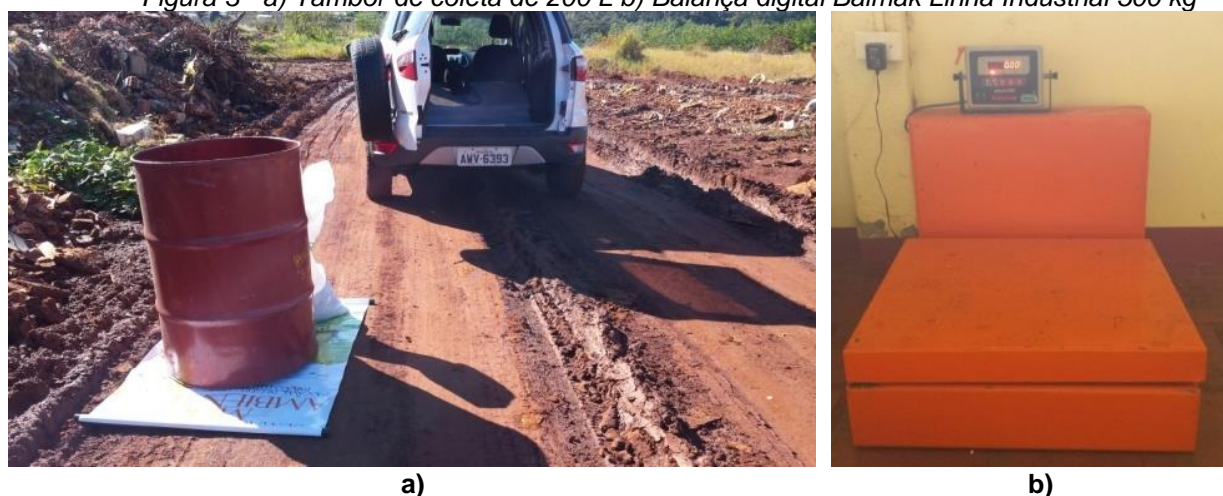
Figura 3 - a) Tambor de coleta de 200 L b) Balança digital Balmak Linha Industrial 500 kg
