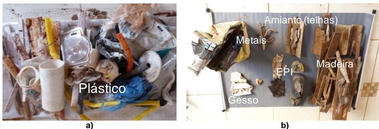
Figura 6 - Separação do resíduo a) Classe B (plásticos) b) Classe B (metais, isopor e madeira) Classe C (outros) Classe D (amianto e EPIs)
