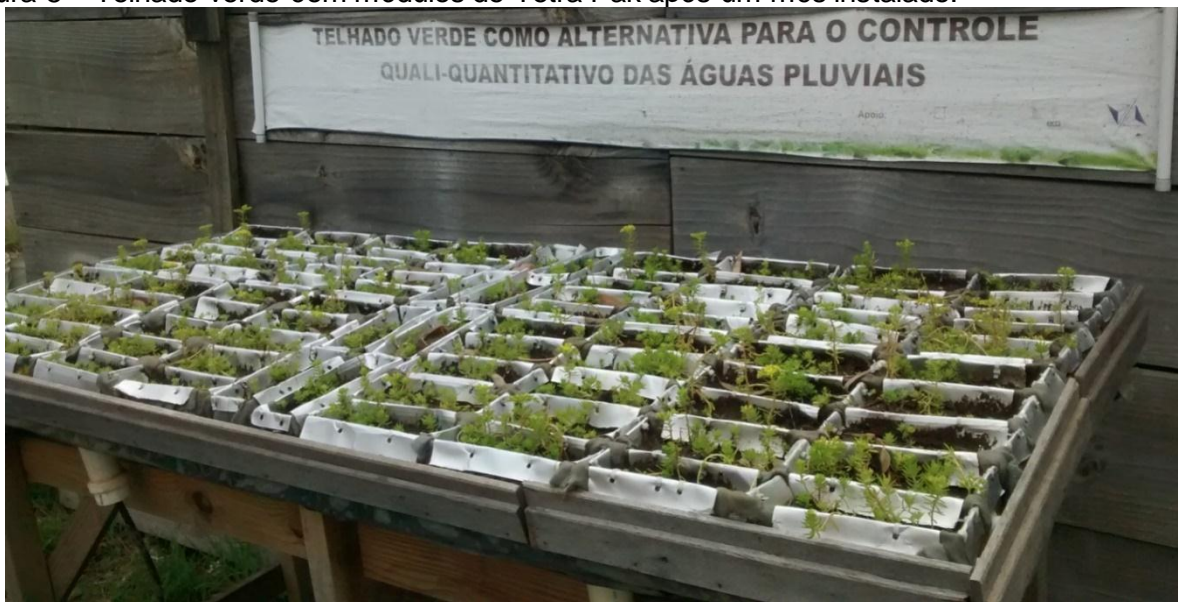
Figura 5 – Telhado verde com módulos de Tetra Pak após um mês instalado.
