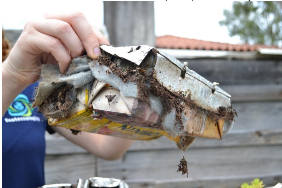
Figura 7 – Um módulo de Tetra Pak® de duas caixas após a quebra de abraçadeiras.
