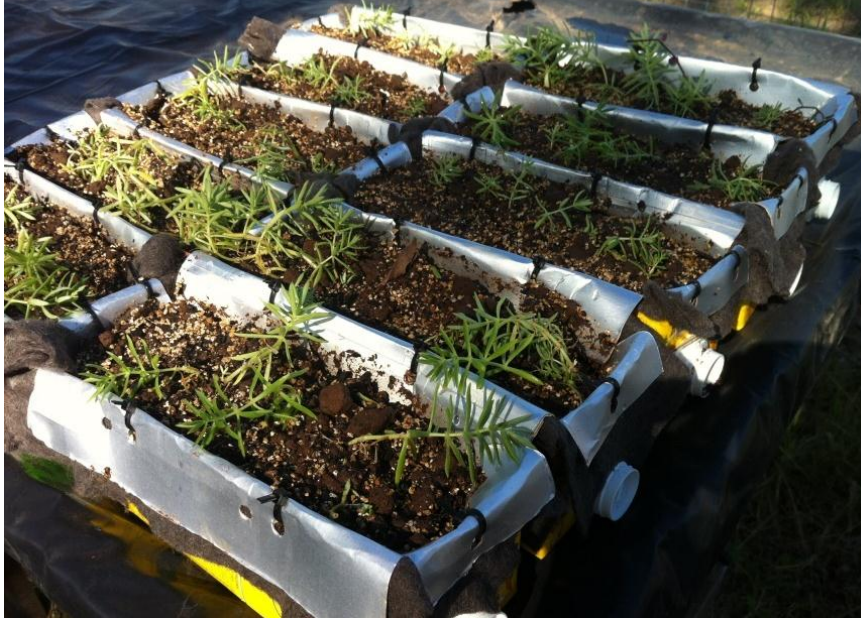
Figura 4 – Módulo de Tetra Pak® preenchido com substrato e a planta Sedum rupestre .
