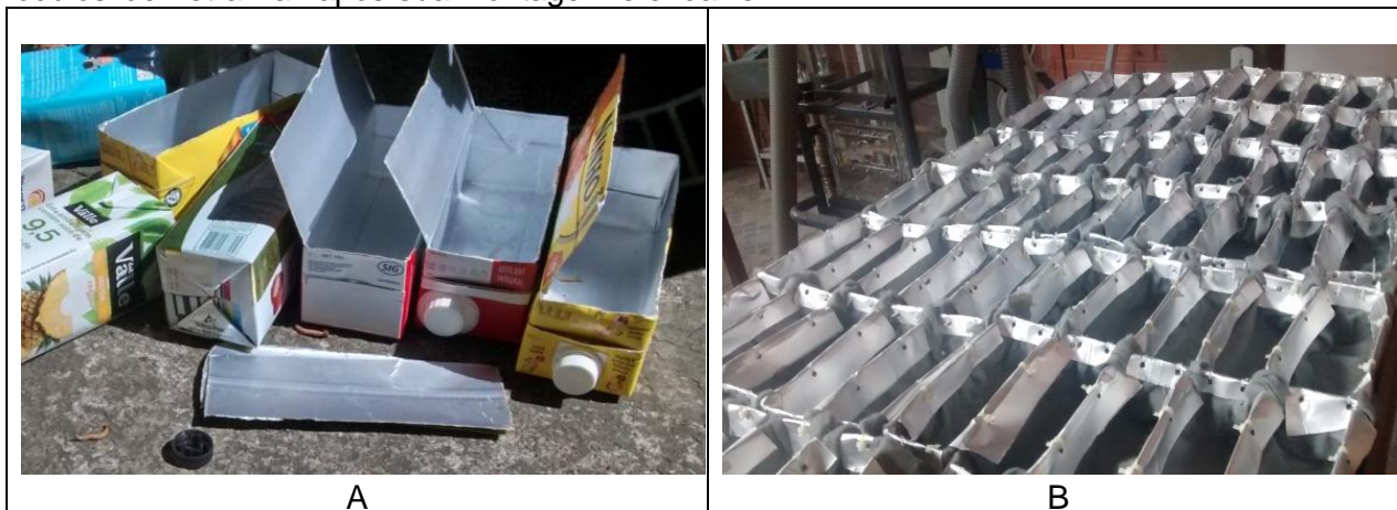
Figura 2– A: Caixas Tetra Pak® em processo de corte das faces para a montagem dos módulos; B: Módulos de Tetra Pak após sua montagem e encaixe.
