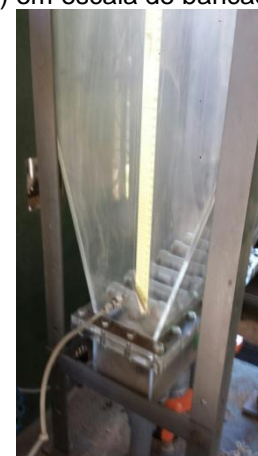
(a) representação do equipamento de fluidização de bancada e seus principais componentes; (b) imagem da coluna de acrílico do fluidizador de bancada com o distribuidor interno de ar no leito.
